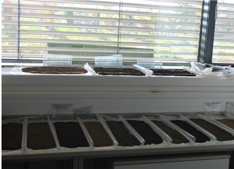
Abbildung 2: Lufttrocknung nach der Probenahme (Quelle: eigenes Material)
