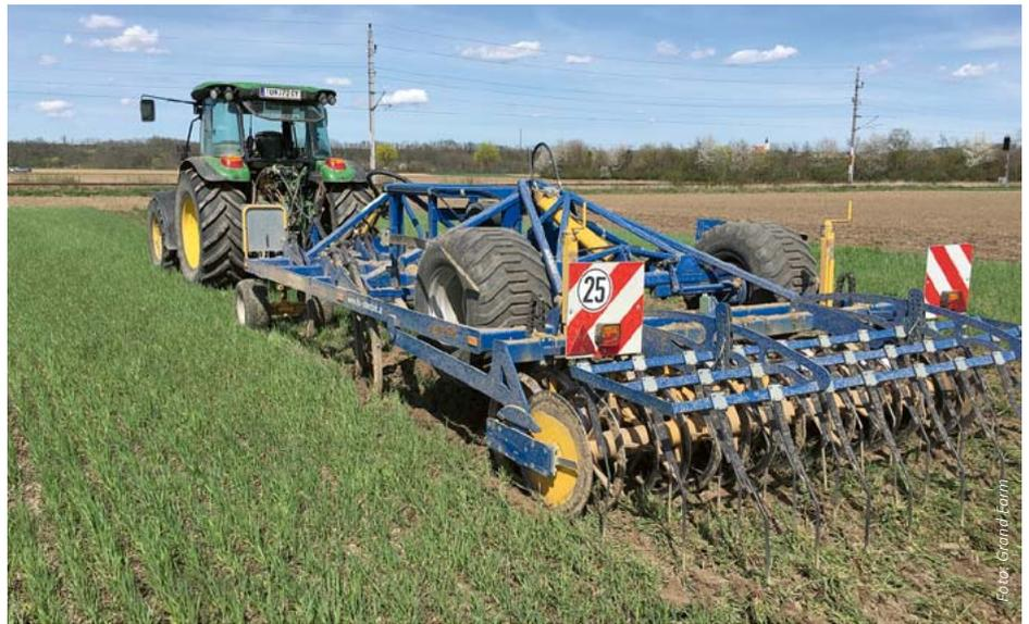
Mit dem Treffler Präzisionsgrubber TG 300 kann Grand ultraflach arbeiten.
