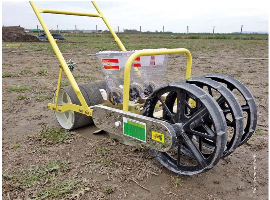
Handarbeit mit Präzisionsgartengeräten: dreireihige Gemüsesämaschine mit Einzelkorndosierung.
