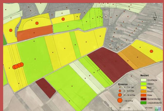
Weiters hat die Analyse gezeigt, dass der Wasserrückhalt am Hang zu gering ist und die Fließwege von den Hängen direkt in das Siedlungsgebiet und hier in den Kanal führen, der nicht für die Entwässerung von Oberflächenwasser aus der Kulturlandschaft dimensioniert ist.
